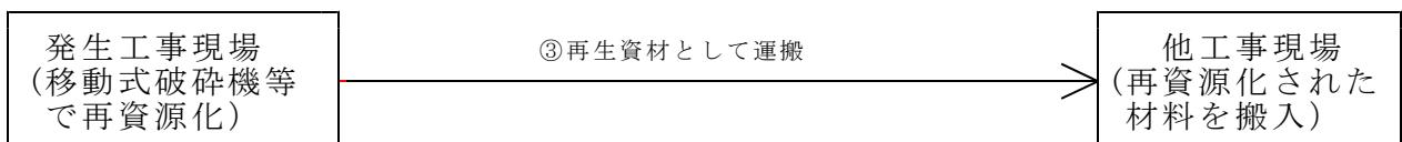
④当該工事現場で発生した状態で他工事現場へ搬出し、他工事現場で再資源化する場合
